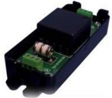
Стандартный функционал с пассивной гальваноразвязкой для приглушения помех и скачков напряжения. Широкий диапазон температур для использования.
