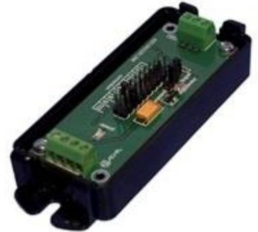
Выполняет функцию приема и передачи видеосигнала с любым типом витой пары. Высокая дальность передачи (до 300 м.). Грозозащита.
